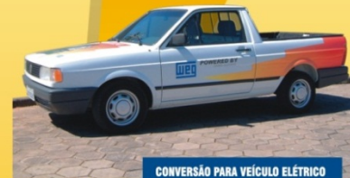
CONVERSÃO PARA VEÍCULO ELÉTRICO INVERSOR + MOTOR DE INDUÇÃO TRAFÁSICO 220V
