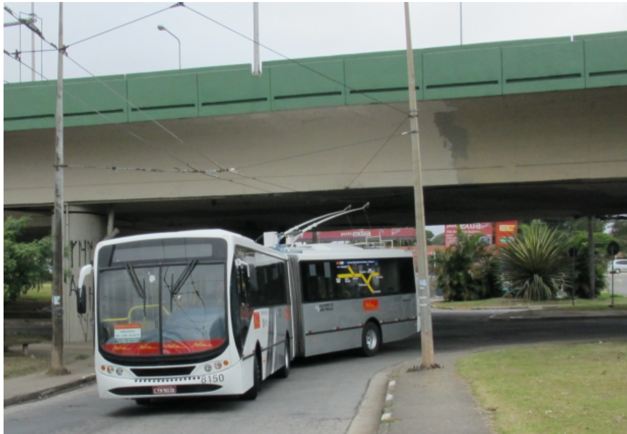
Trólebus Articulado 18 metros, com motor e inversor tração WEG 210kW 6P.
